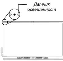
Датчик освещенности расположен в левом верхнем углу рамки дисплея.
